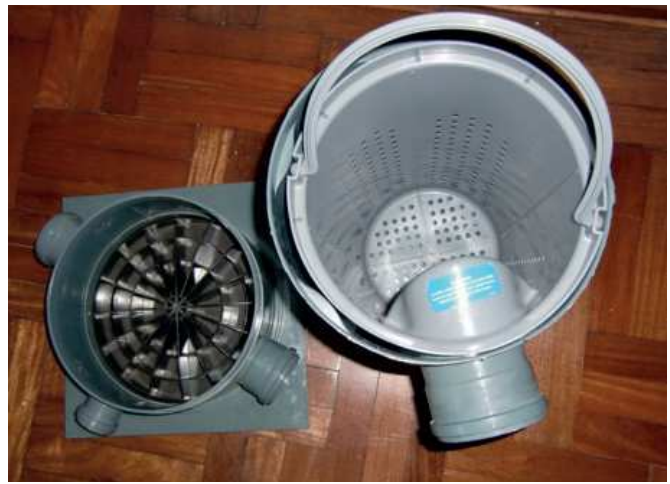
Figure 5: Dégraisseur à l'échelle d'un ménage muni d'un seau intérieur qui est retiré pour éliminer la graisse accumulée. En haut à gauche: Schéma. En haut à droite: Dégraisseur utilisé pour l'effluent d'un évier de cuisine comme traitement préliminaire d'un filtre planté à Lima, Pérou. En bas: Composantes d'un dégraisseur individuel (source: H. Hoffmann, 2010; entreprise TIGRE s/a).
