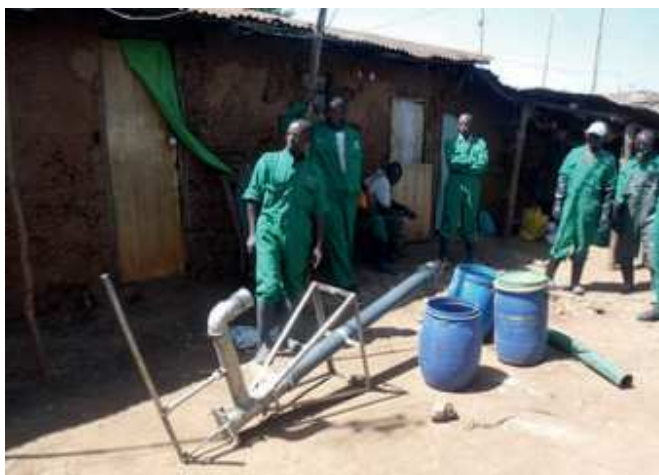
Figure 2: Préparatifs précédant l'utilisation d'une pompe manuelle « Gulper » pour la vidange d'une fosse de latrine traditionnelle à Kibera, Nairobi, Kenya (source: D. Mbalo, 2012).
