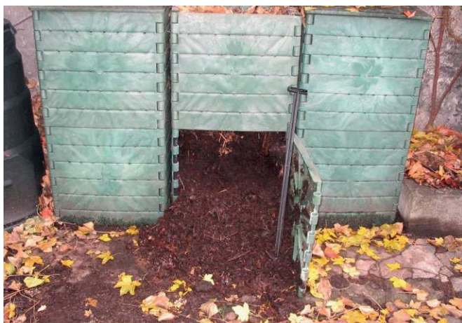
Figure 6: Exemple de système modulaire individuel de compostage en containers ou mini-chambres. Les containers sont remplis un après l'autre (source: W. Berger, 2004).
