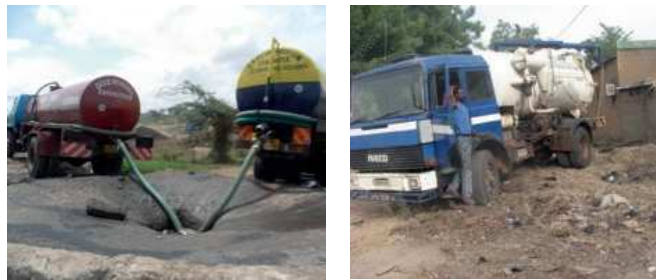
Figure 2: A gauche: Décharge de boues de vidange collectées par les camions de vidange à un point de réception dans une station d'épuration à Nairobi, Kenya (source: D. Mbalo, 2012); A droite: Vidange de la fosse septique d'un hôtel à Fada N'Gourma, Burkina Faso (source: F. Erzinger, 2007).
