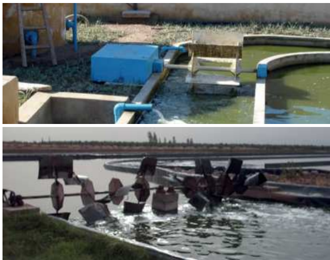
Figure 2: Roue à palettes pour chenal algal. En haut: solution classique avec une roue à huit palettes rigides fabriquées en polyester résistant dans une installation à Casablanca. En bas: station d'El Attaouia roue à palettes multiples en caoutchouc épais souple placées sur différents plans; chenal algal de 6400 m 2 (source: B. El Hamouri, 2006).
