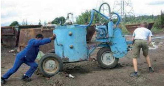
Figure 3: VacuTug en test dans une communauté de la municipalité Msunduzi en Afrique du Sud, avec toilettes à faible débit (source: WRC, 2012).
