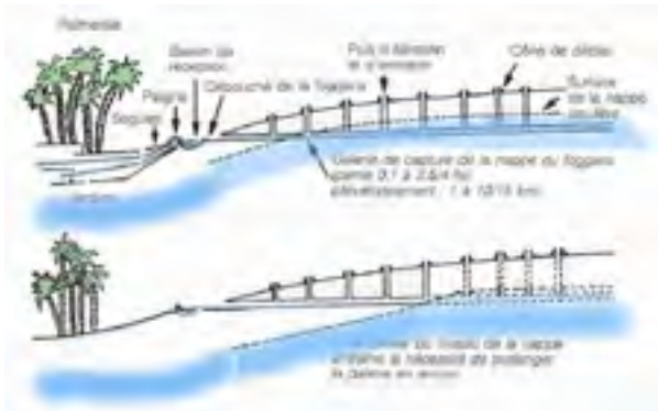
Figure 9 : Schéma d'une Khattara dénoyée (Source : http://zoumine.free.fr/tt/sahara/donnees_geo_climatiques/eauausahara.html )
