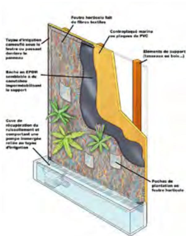
Figure 2 : Composition d'un mur végétalisé (Source : Med & Fuchs, 2009)
