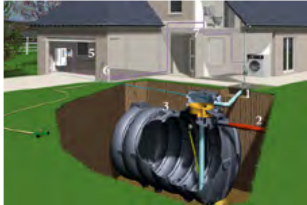
Figure 1 : Schéma d'un système de collecte d'eau de toiture en milieu urbain (Source : https://www.systemed.fr/conseils-bricolage/recuperer-l-eau-pluie-installer-cuve-enterree,2499.html )
