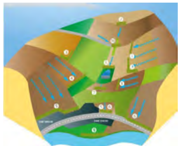
Figure 2 : Localisations pertinentes des haies et des fascines pour réduire l'érosion des sols (Source : AREAS, 2012)
