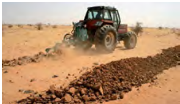
Figure 2 : Charrue Delfino montée un tracteur réalisant des valleranis (Source : http://bft.cirad.fr/cd/BFT_304_61-71.pdf )
