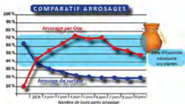
Figure 3 : Schéma comparatif d'arrosage par jarre avec l'arrosage de surface (Source : http://www.oyas-environnement.com/index.html )
