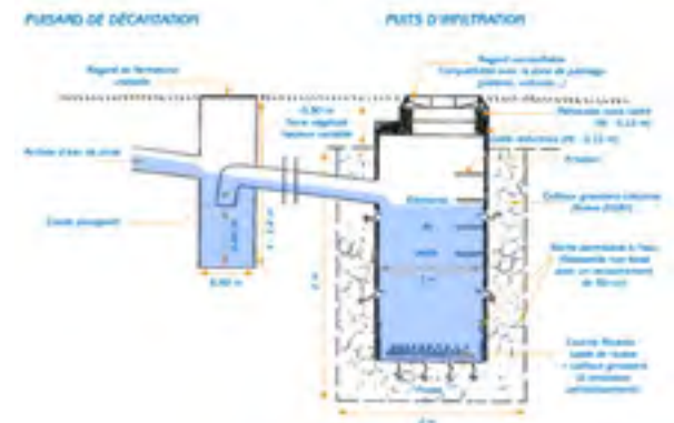
Figure 3 : Puits d'infiltration couplé à un regard de décantation (Source : https://adopta.fr/wp-content/uploads/2016/07/FicheTechnique-1_ADOPTA.pdf )
