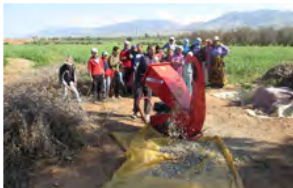
Figure 4 : Production du BRF avec un broyeur semi-professionnel (Source : AFEMAC Maroc)
